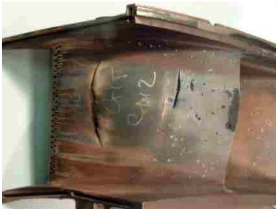
Figure 2-2 HP NGV Distress (左写真) マニュアルでは修理方法は無く廃棄となる 状況である。 しかしながら、Repair Vender の開発した 修理方法により再生が可能である。
