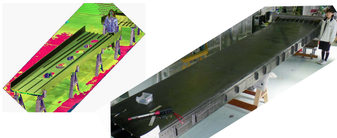
図 1 2 JAXA の開発した VaRTM 成形技術により成形した 6m 実大主翼構造模型
