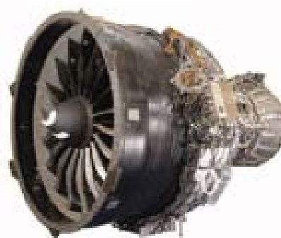
図 4. 2-3 PMC 製のファンブレード、およびファンケース 5)
