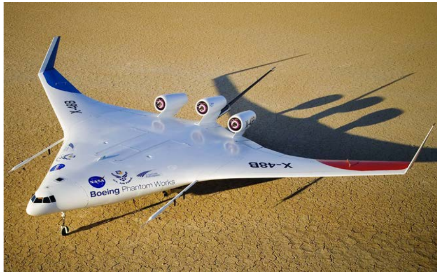
図 1 0 NASA-Boeing で研究中の Blended Wing Body コンセプト研究機 5)
