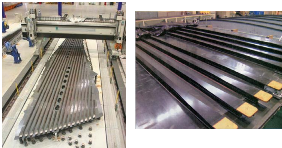
図5 787 の主翼外板の製造中の写真と、補強材の中央翼への継手部
