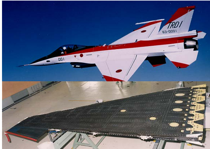
図3 我が国で初めての CFRP の主翼適用事例である F-2 戦闘機 2)
