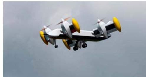
図 2. QTW-UAS 実証機 Akitsu<sup>7)</sup>
