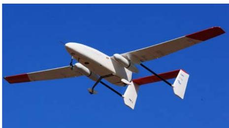
図 1. 放射線モニタリングシステム原型機<sup>6)</sup>
