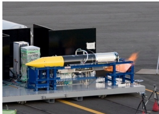
図2 極超音速ターボジェットの地上燃焼実験
