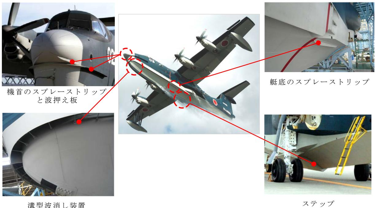
図 7 「STOL 飛行艇の水力デバイス」
