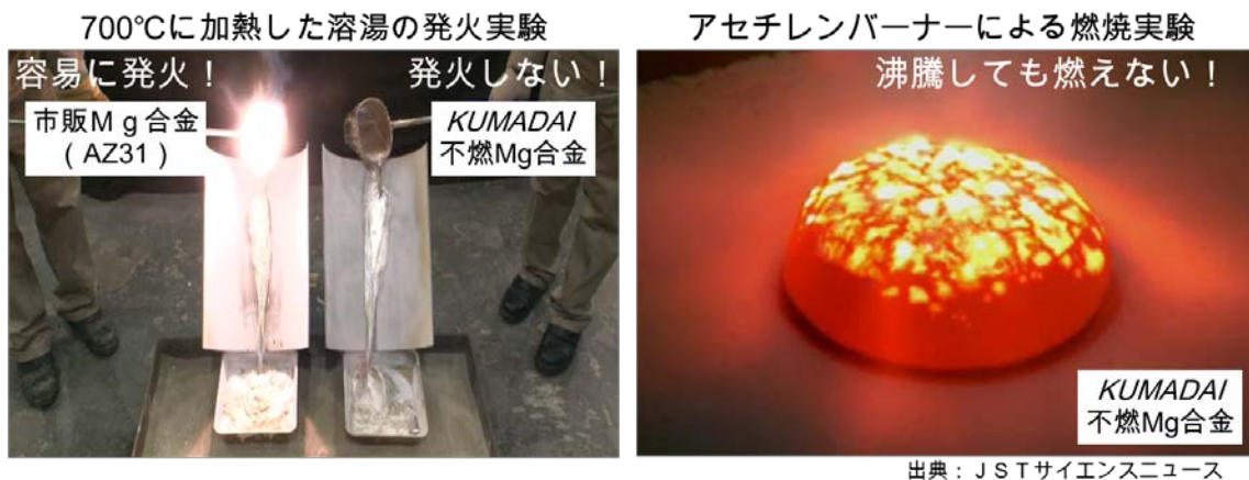
図 6 KUMADAI 不燃マグネシウム合金の高い発火温度
