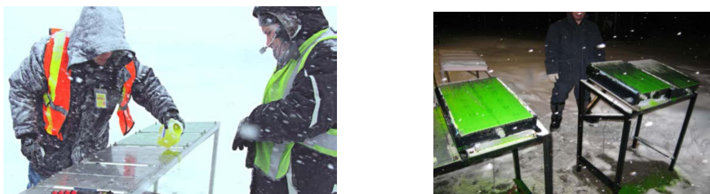
写真1 ホールドオーバータイム試験
