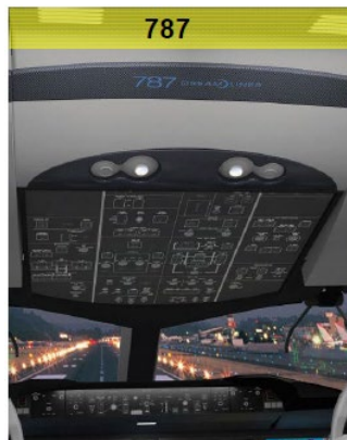
図 2.3.9 操縦室オーバー・ヘッド・パネル 8)
