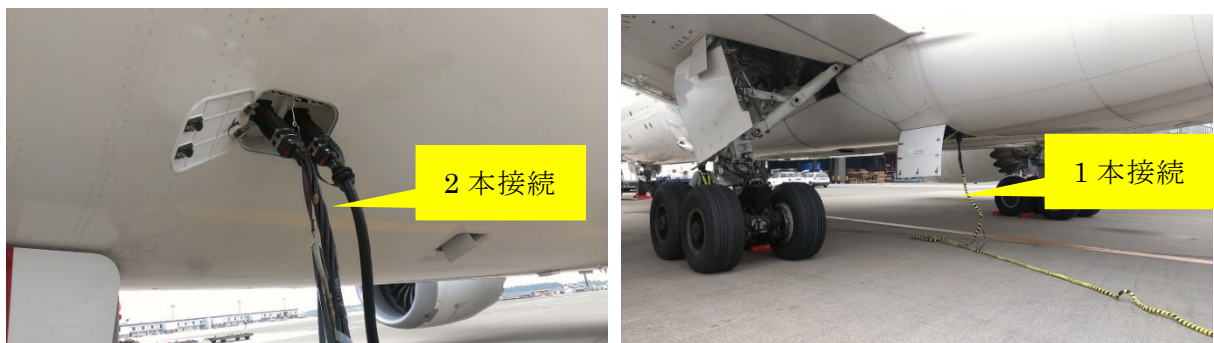
図 2.3.3 787 型機 エンジン・スタートの状況 (羽田空港) ⑥
