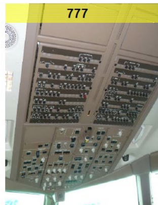
図 2.3.9 操縦室オーバー・ヘッド・パネル 8)
