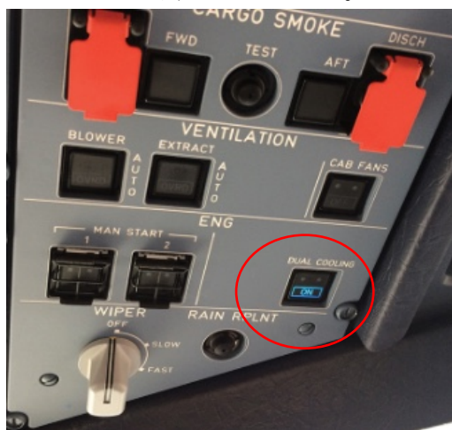
図 2. 3. 2－3 A320neo 5 号機から導入された“DUAL COOLING”システム
