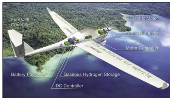
図 5. ボーイング社の固体高分子型燃料電池 (PEFC) 動力デモ飛行機 3)
