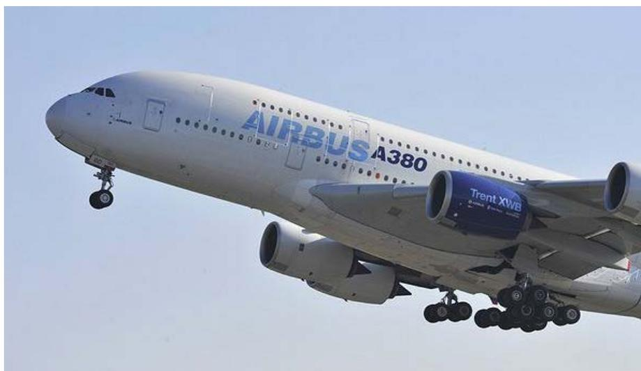
図2. 3. 2-1 A380 フライイング・テスト・ベッドに搭載され飛行試験中のトレント XWB (右から2つめのエンジン) (Flightglobal)
