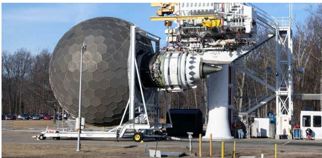
図 2.3.2-2 CMC 部品を GEEnx-1B デモエンジンに組込んだ耐久試験の様子 (7)
