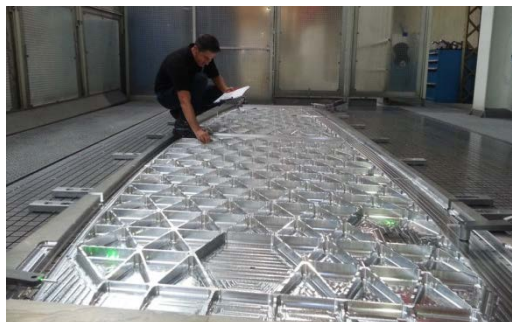
図 2.3.1.3-1 A330neo のアイソグリッド構造中央ウイングボックスリブ (47)
